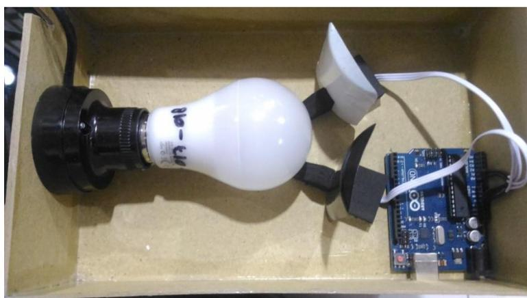
**Gambar 1.** Rangkaian Alat Serapan Kalor
