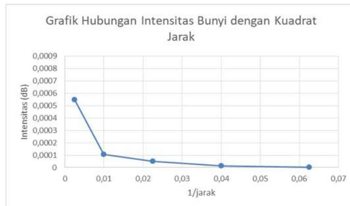
**Gambar 2.** Grafik Hubungan Intensitas Bunyi dengan Kuadrat Jarak
