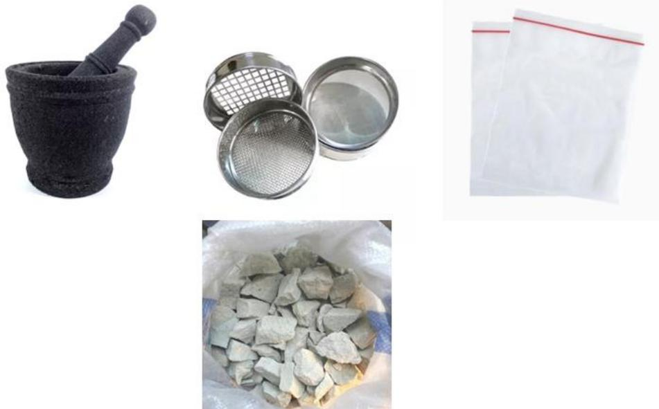
Gambar 3. Peralatan dan bahan yang digunakan pada pelatihan pengolahan zeolit menjadi pasir kucing, lumpang dan lesung (kiri), ayakan (tengah), kantong plastik (kanan) dan contoh batuan zeolit (bawah).
