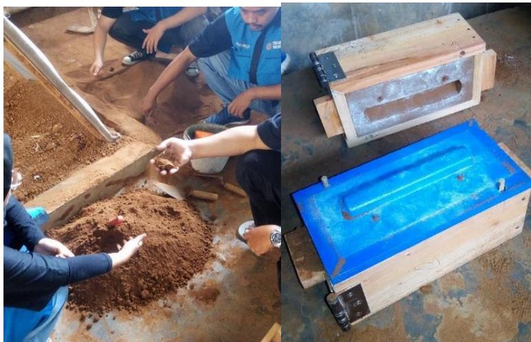
Gambar 7. Uji coba penggunaan *sand mold casting kit*
