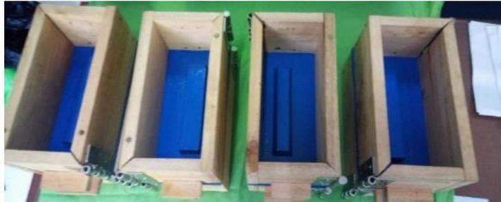
Gambar 5. Pola pelat dan rangka cetak
