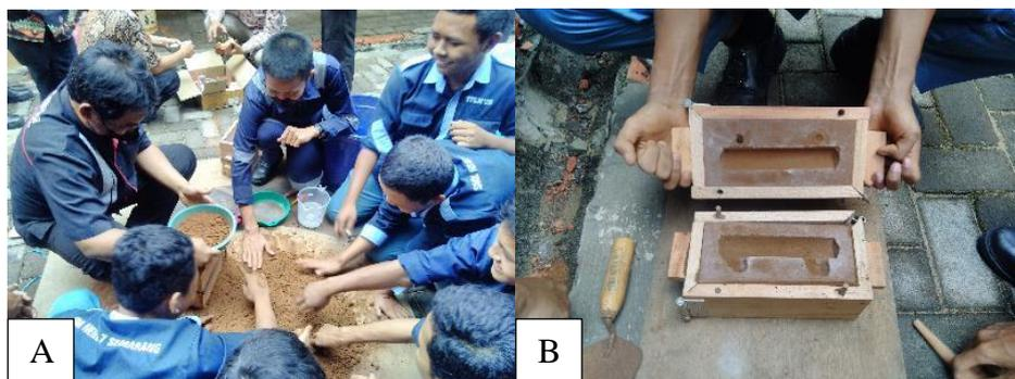
Gambar 10. Menyiapkan pasir cetak (A) dan membuat cetakan (B)
