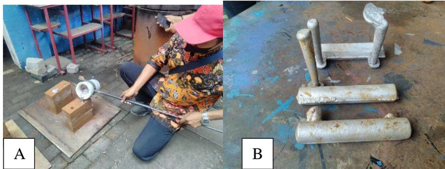
Gambar 11. Proses penuangan logam cair (A) dan hasil coran (B)
