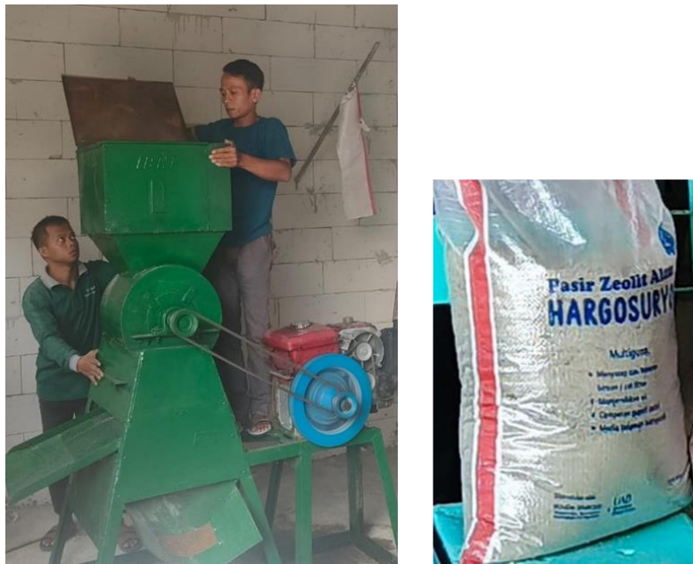
Gambar 8. Praktik operasional mesin crusher untuk produksi pasir zeolit alam
