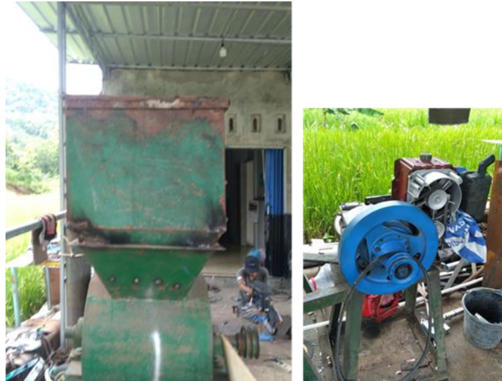
Gambar 6. Mesin pencacah zeolit alam: bodi mesin pencacah (kiri) dan roda penggerak dengan genset (kanan)
