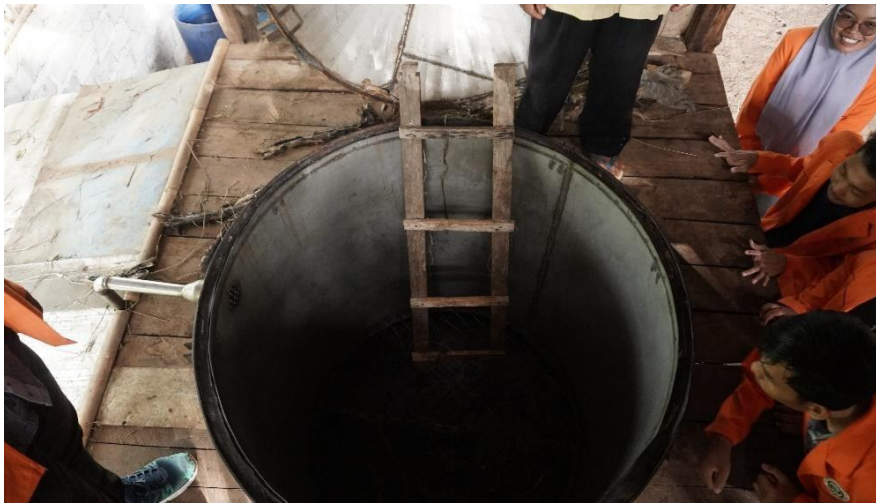
Gambar 2. Alat penyulingan yang digunakan dalam pembuatan minyak atsiri
