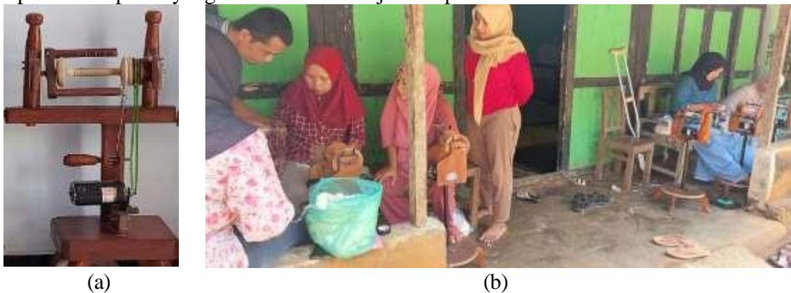
Gambar 2. Mesin pintal benang sutera singkong, visualisasi mesin pintal (a) dan pelatihan pengoperasian mesin pintal (b)
