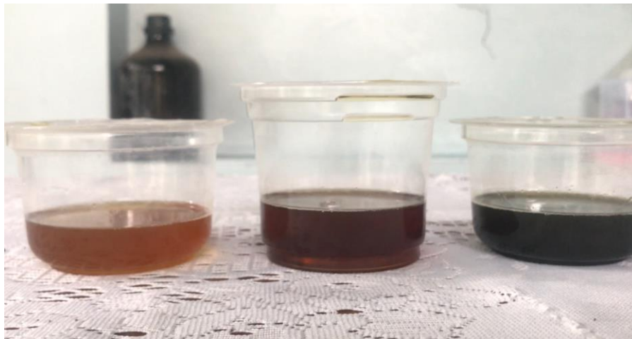
Gambar 4. Minyak jelantah yang dijernihkan dari kiri ke kanan hasil penjernihan 2 x 24 jam, 2 jam dan minyak jelantah belum dijernihkan.
