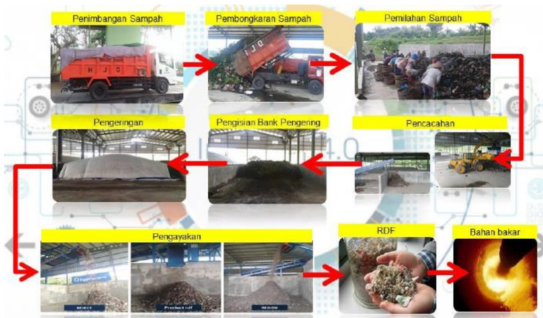
Gambar 3. Proses pengolahan sampah menjadi RDF
