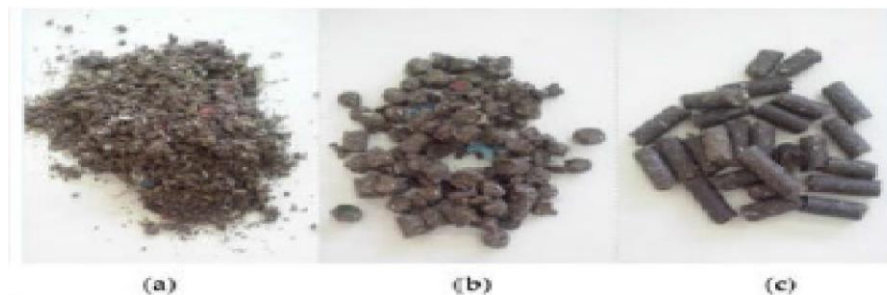
Gambar 4. Jenis-jenis RDF: (a) Fluff; (b) Pellet; (c) Briket.
