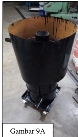
Gambar 9. Pengerjaan akhir (9A) dan Produk akhir dapur pelebur (9B)
