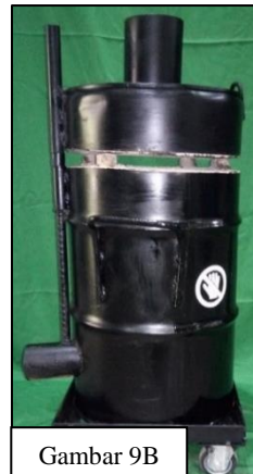
Gambar 9. Pengerjaan akhir (9A) dan Produk akhir dapur pelebur (9B)
